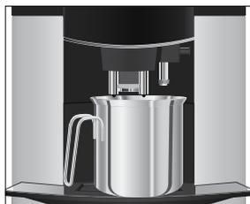
Ti minutter etter melketilberedningen krever D6 en skylling av melkesystemet.
